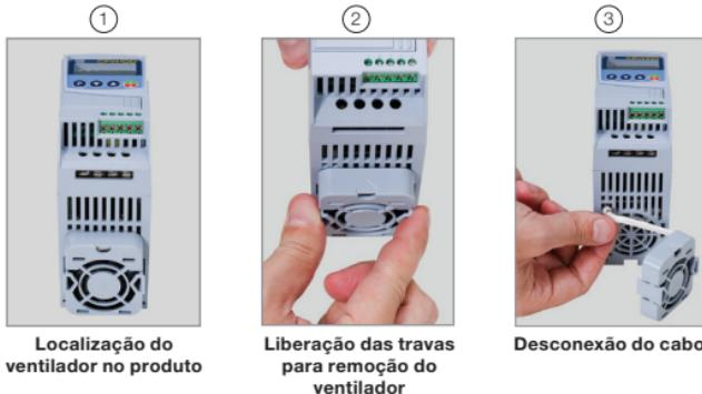
Figura 6.1: Retirada do ventilador do dissipador
