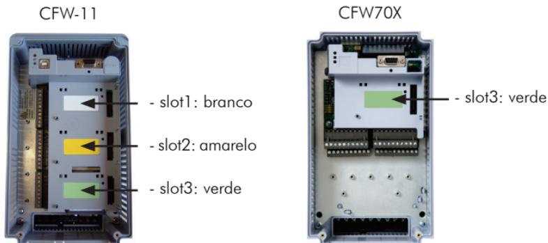
**Figura 1:** Identificação de slots para acessórios
