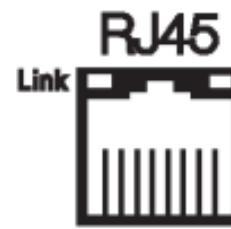
Además de las conexiones de control, el módulo tiene un conector para la interfaz Ethernet, que sigue el estándar Fast Ethernet 100Base-TX
