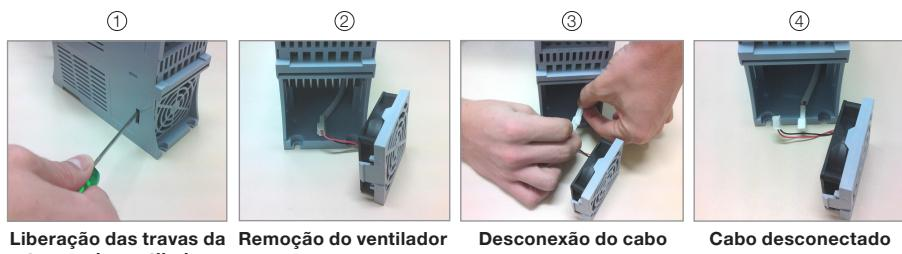
Figura 6.1: Retirada do ventilador do dissipador
