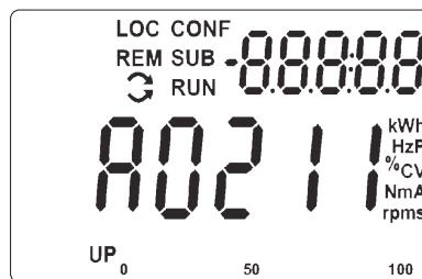
*Figura 5.1: Display de la HMI al energizar*
