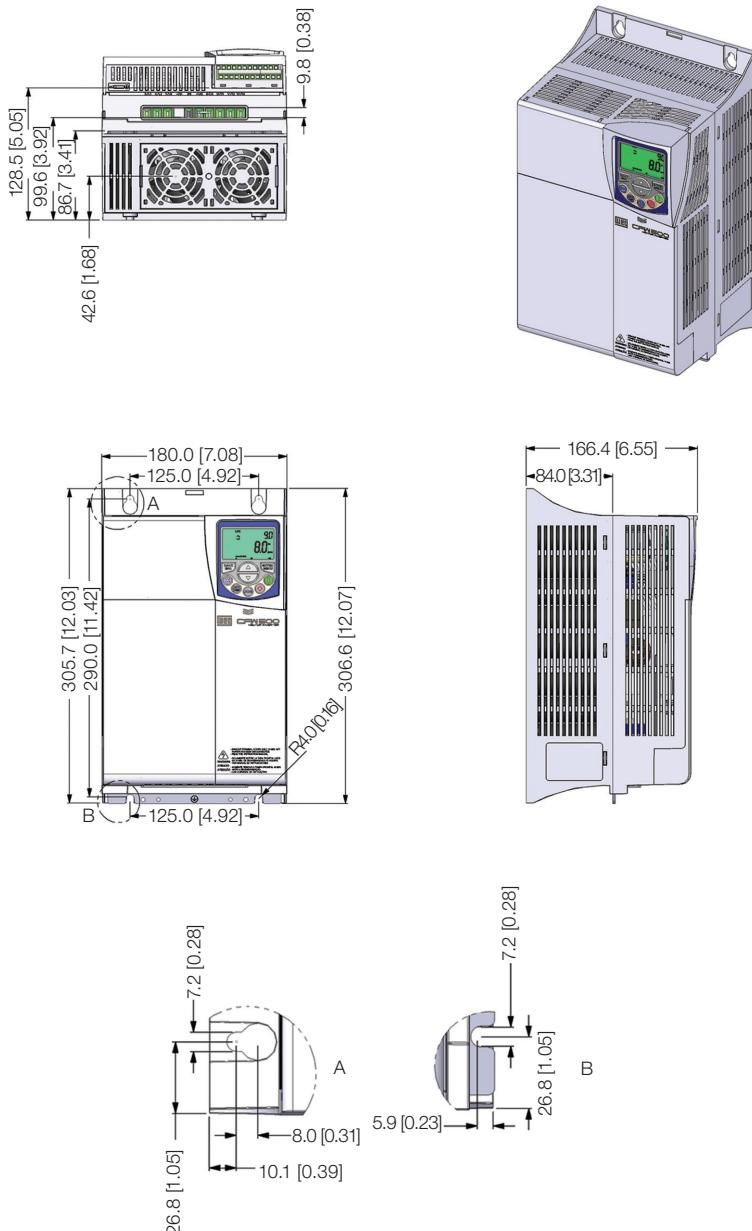
**Figure B.8:** Inverter dimensions in mm [in] - frame size D**Figura B.8:** Dimensiones del convertidor de frecuencia en mm [in] - tamaño D**Figura B.8:** Dimensões do inverter em mm [in] - mecânica D
