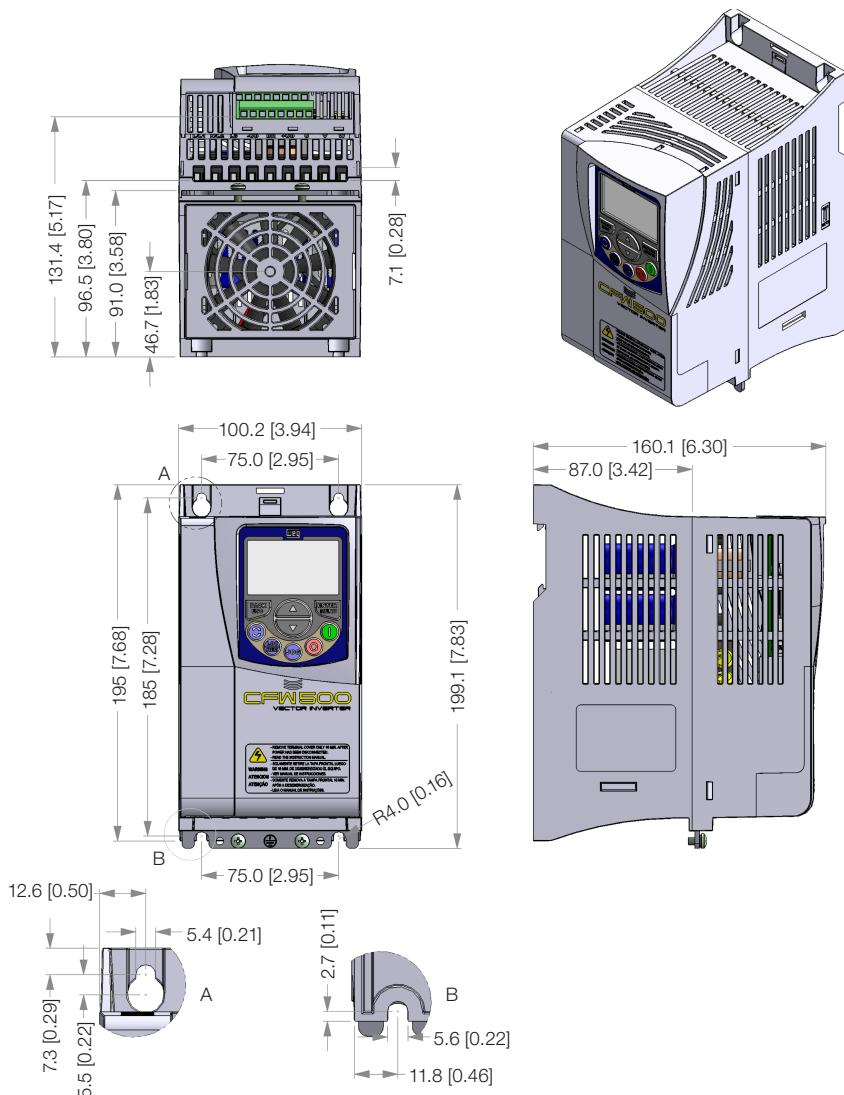
**Figure B.6:** Inverter dimensions in mm [in] - frame size B**Figura B.6:** Dimensiones del convertidor de frecuencia en mm [in] - tamaño B**Figura B.6:** Dimensões do inversor em mm [in] - mecânica B
