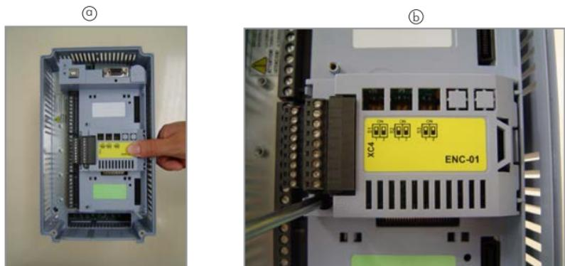
Figura 3: Instalación del módulo opcional en el “slot”
