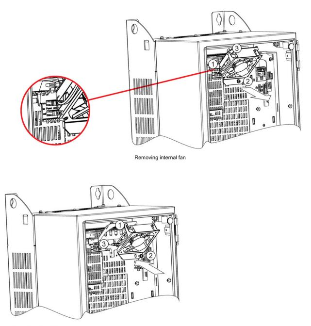
Replacing internal fan
