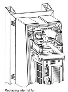
Removing internal fan
