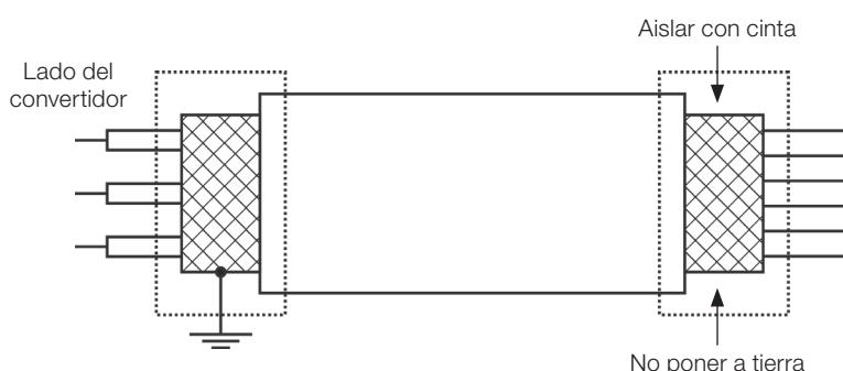
*Figura 3.3: Conexión del blindaje*
