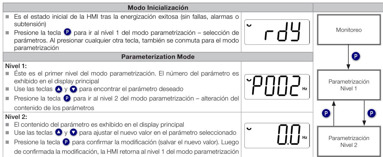
Figura 4.3: Modos de operación de la HMI
