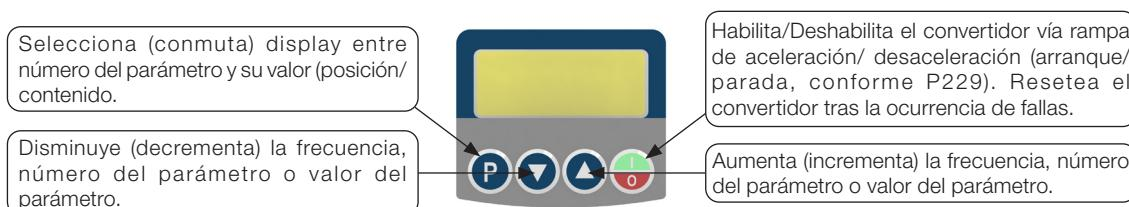
Figura 4.1: Teclas de la HMI
