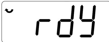
*Figura 5.1: Display de la HMI al energizar*
