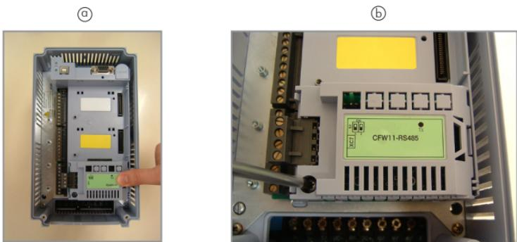
Figura 3: Instalação do acessório no slot
