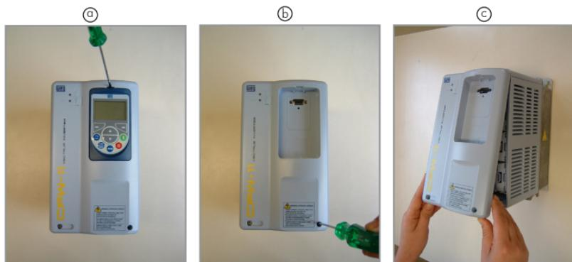
Figura 2: Remoção da tampa frontal
