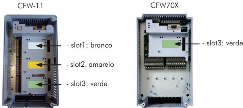
**Figura 1:** Identificação de slots para acessórios
