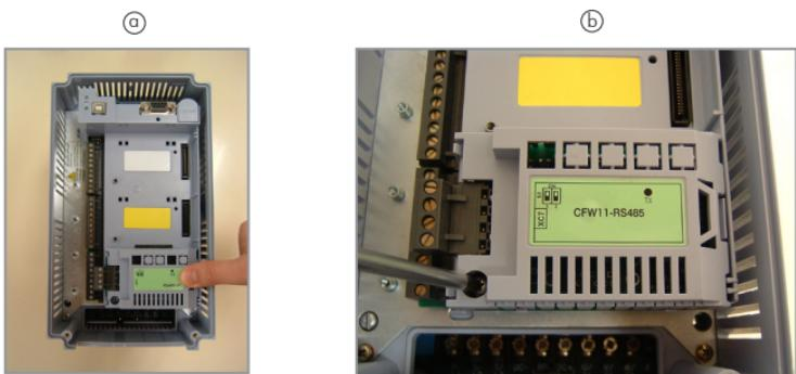
Figura 3: Instalación del accesorio en el “slot”
