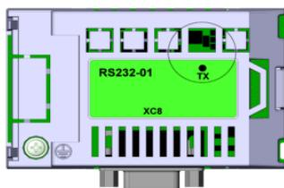
Figura 4: LEDs de indicación para la interfaz RS-232
