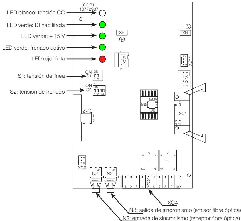
Figura 3.7: Puntos de conexión de la tarjeta CDB1
