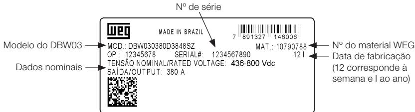
**Figura 2.5:** Exemplo de etiqueta de identificação do DBW03
