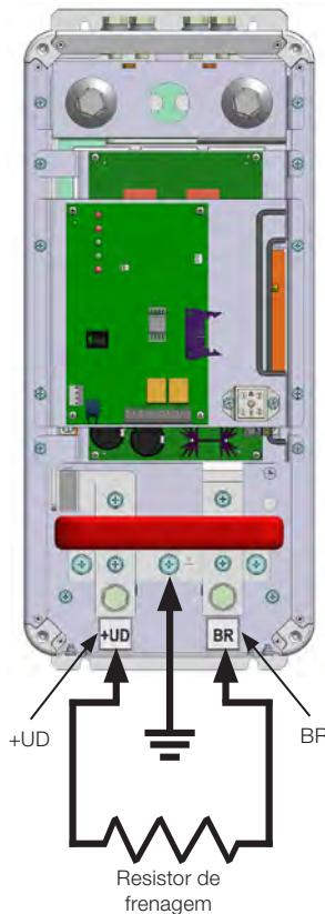
**Figura 3.4:** Conexões do resistor de frenagem e aterrramento
