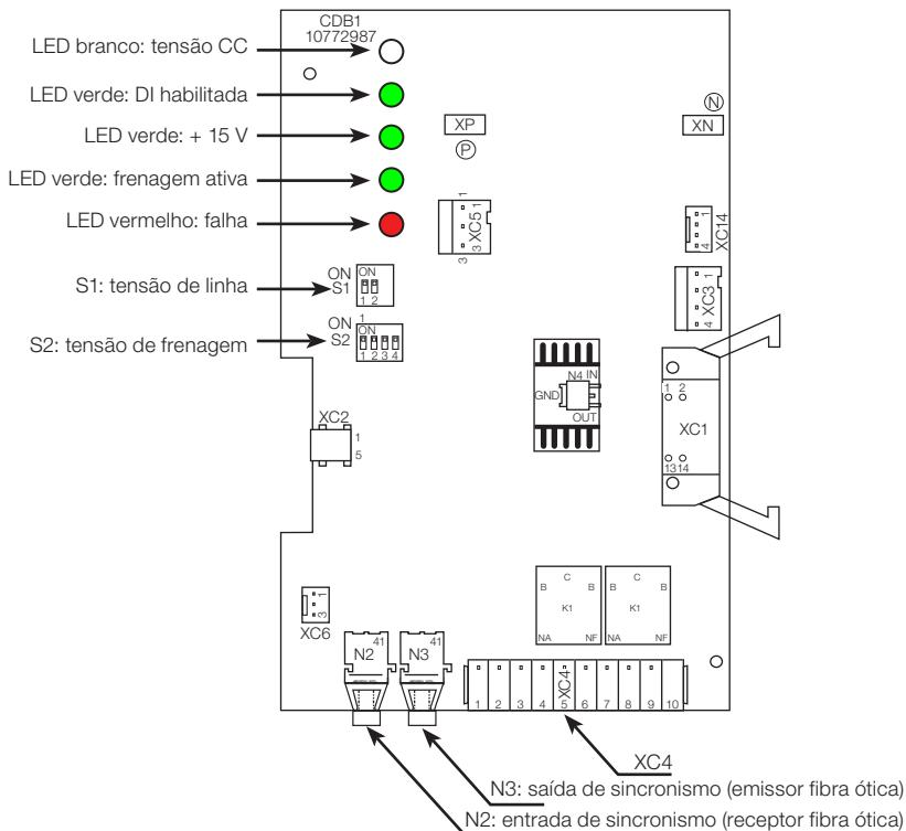
**Figura 3.7:** Pontos de conexão do cartão CDB1
