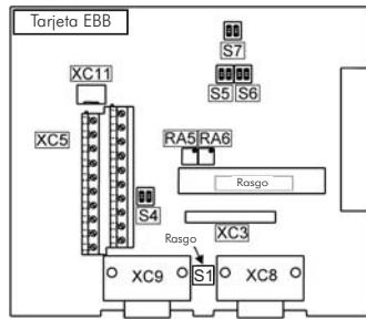
**Figura 5:** Conectores de configuración de la tarjeta EBB
