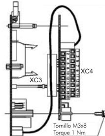
Figura 3: Encaje de los tornillos EBA/EBB - Vista lateral
