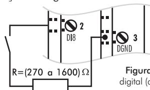
Figura 10: Conexão da DI8 como entrada digital (qualquer função em P270 exceto a 16)
