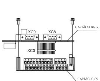
Figura 1: Encaixe do conector XC3
