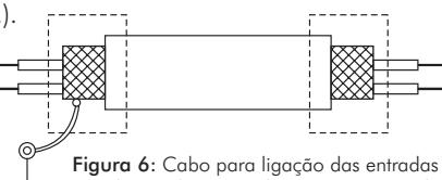
**Figura 6:** Cabo para ligação das entradas e saídas analógicas e digitais e conexão da blindagem (ver item 3.2.1)
