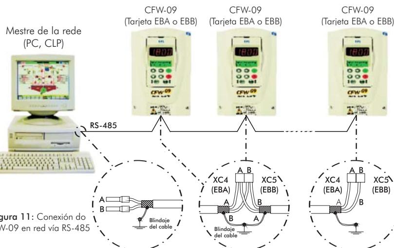
Figura 11: Conexión del CFW-09 en red vía RS-485
