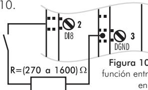
Figura 10: Conexión de la DI8 con la función entrada digital. (quiero función en P270 excepto la 16)
