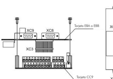
Figura 1: Encaje del conector XC3 - EBA/EBB - Vista frontal
