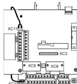
Figura 2: Encaixe do conector XC11
