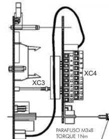
Figura 3: Encaixe dos parafusos
