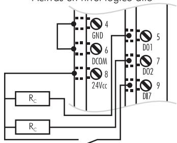
Figura 7: Configuración de las entradas y salidas digitales para ACTIVO en nivel lógico ALTO
