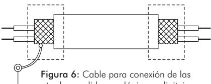
Figura 6: Cable para conexión de las entradas y salidas analógicas y digitales y conexión de la blindaje (ver ítem 3.2.1)
