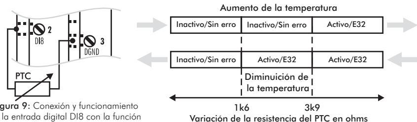
Figura 9: Conexión y funcionamiento de la entrada digital DI8 con la función termistor del motor (P270=16)
