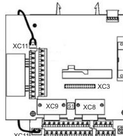
Figura 2: Encaje del conector XC11 - EBA/EBB - Vista superior
