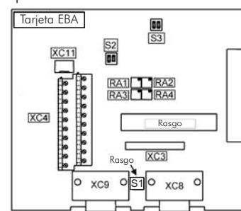
Figura 4: Conector de configuración de la tarjeta EBA
